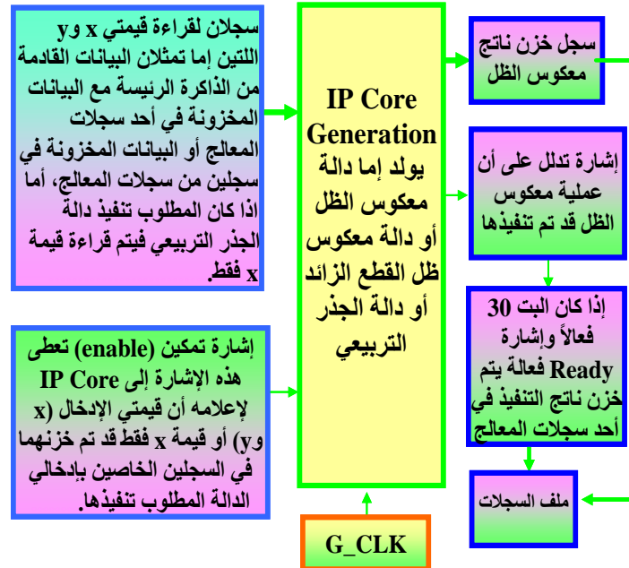
الشكل (10) عملية معكوس الظل المنفذ بأسلوب خط الأنابيب
