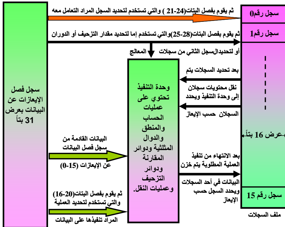
الشكل (6) الرسم التخطيطي لوحدة تنفيذ الإيعازات
